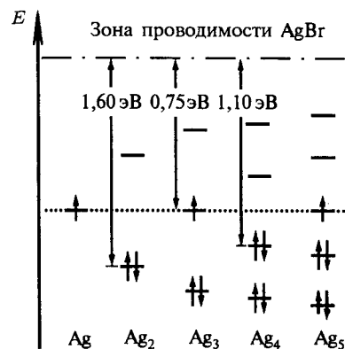
Рис. 71. Изменение энергии ионизации для кластеров Ag_2^0 , Ag_3^0 и Ag_4^0 по данным оптических экспериментов [47]
