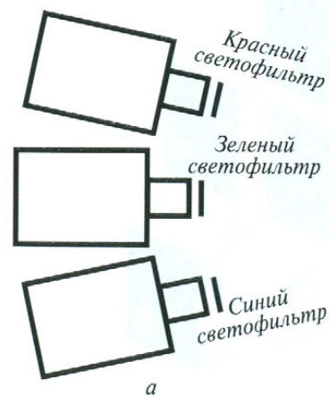
Рис. 142. Принцип аддитивного смешения цветов
