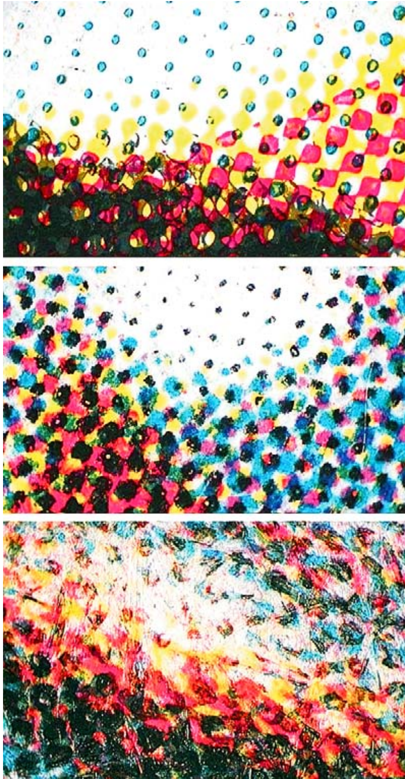
Рис. 26.1 Микрофотографии мелких участков изображений, отпечатанных методами четырех-красочной высокой ( вверху ), литографской ( в центре ) и глубокой печати ( внизу ). Сильно увеличено.
