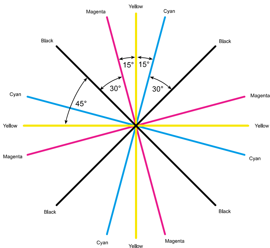
Рис. 26.6 Углы поворота растров, обычно применяемые в четырехкрасочной печати.
