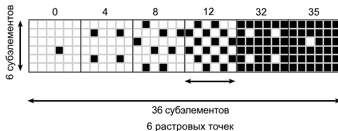
Рис. 33.7 Дисперсия субэлементов в растровой ячейке 6×6. Позиции субэлементов подобраны исходя из принципа минимальной визуальной различимости растровой структуры изображения.
