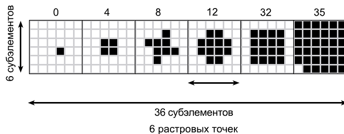
Рис. 33.6 Сборка кластера печатных субэлементов в растровой ячейке 6×6. Позиции субэлементов подобраны так, что образующиеся печатные элементы по форме аппроксимируют традиционные полутоновые точки 36 возможных размеров, что дает 37 тоновых градаций (37 тональных уровней).
