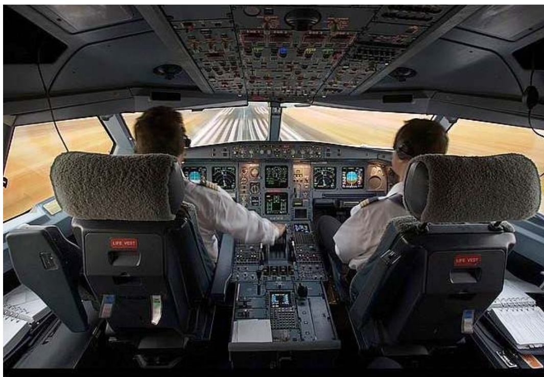
Рис. 25.3 Вверху : компьютерная имитация кабины боевого самолета и взлетно-посадочной полосы. Внизу : кабина тренажера пилотов гражданской авиации. Для большей реалистичности растровые дисплеи (см. раздел 25.6), управляемые компьютером и имитирующие в данном примере взлетно-посадочную полосу, вмонтированы в окна кабины.
