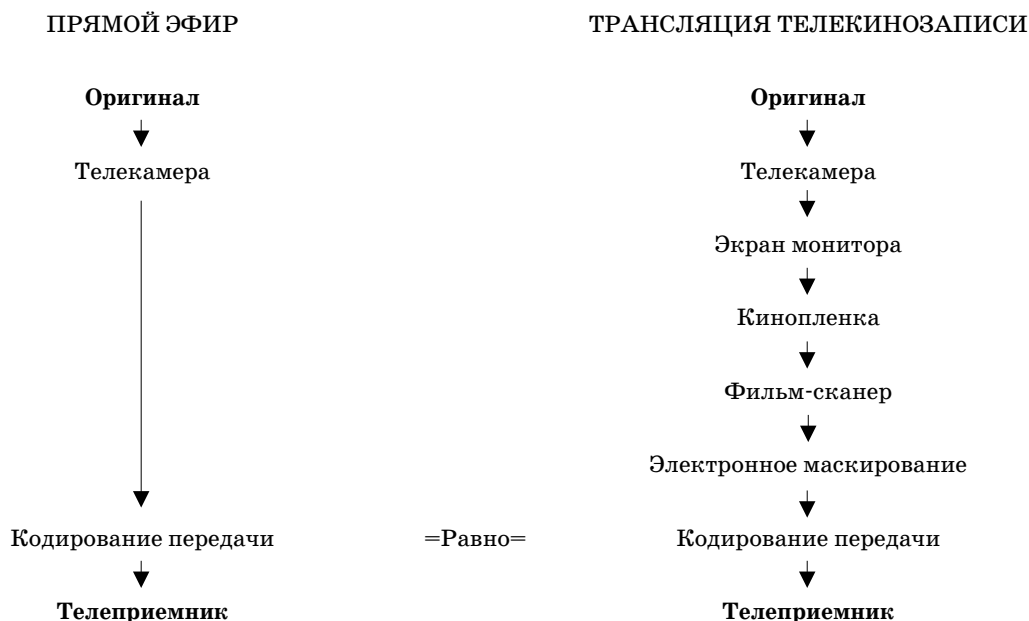
Рис. 23.7 Сравнение последовательности операций при телетрансляции одной и той же программы, идущей в прямом эфире и записанной кинопленку.
