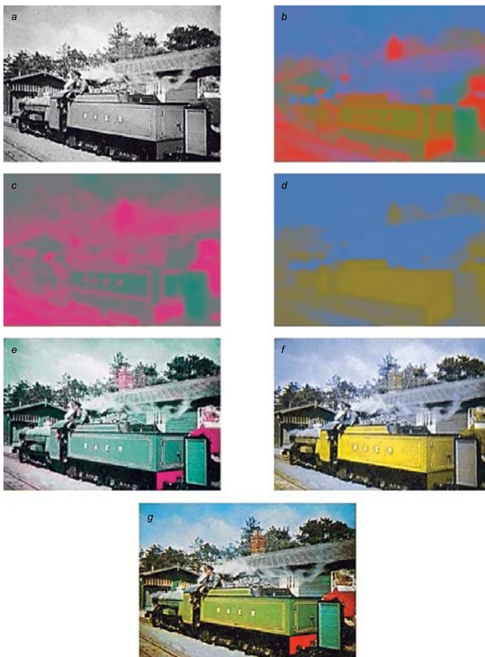
Рис. 19.2 Визуализация телеприемником различных PAL-сигналов (см. разделы 22.6 и 22.8): a — только яркостный сигнал; b — только цветоразностные сигналы E'_R - E'_Y и E'_B - E'_Y ; c — только E'_R - E'_Y -сигнал; d — только E'_B - E'_Y -сигнал; e — только яркостный и E'_R - E'_Y -сигналы; f — только яркостный и E'_B - E'_Y -сигналы; g — полный комплект сигналов.
