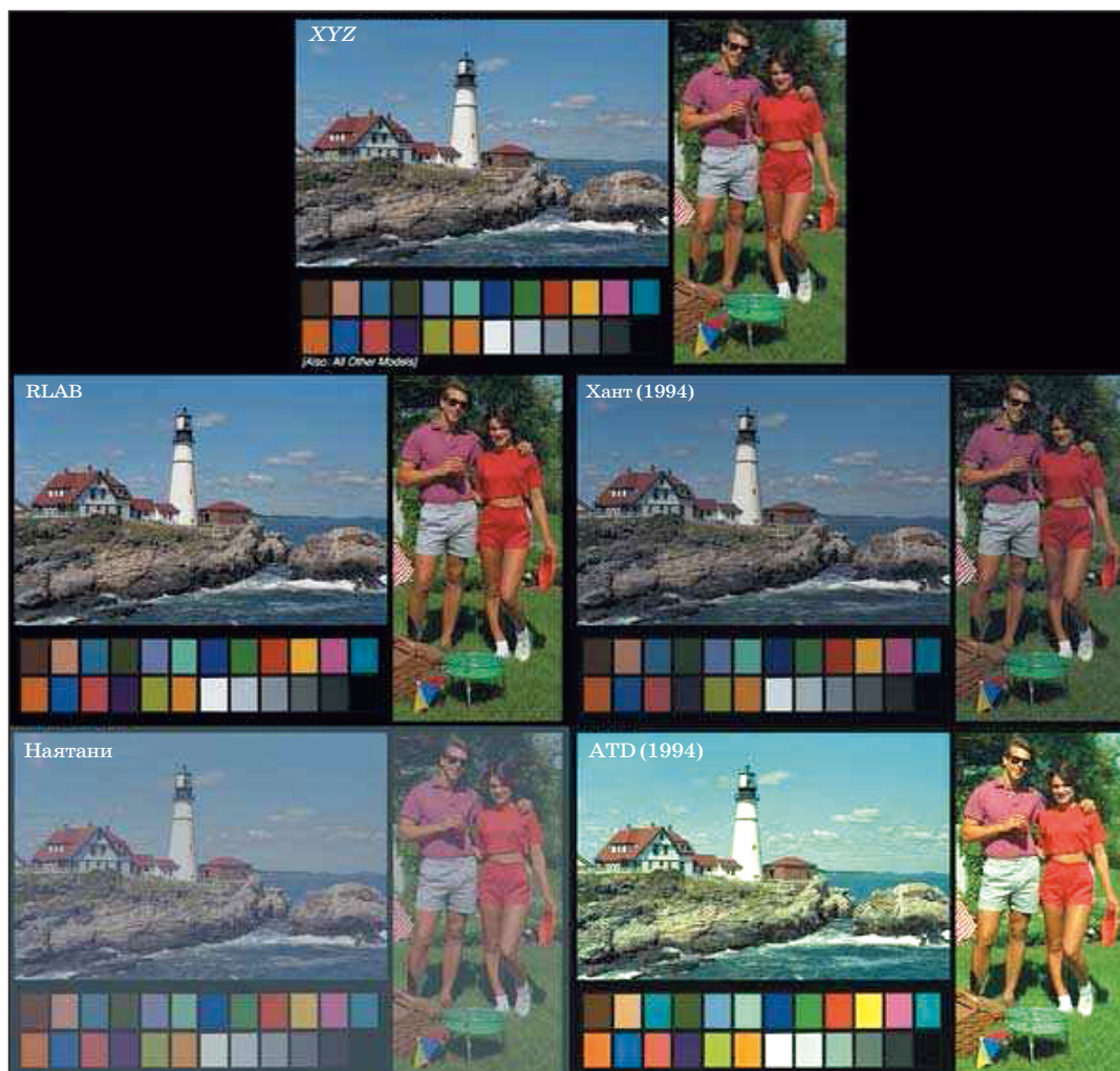
Рис. 17.5 Сравнение прогнозов, выполненных различными моделями цветового восприятия для ситуации перехода от фотометрической яркости D65-осветителя в 100 \text{ cd/m}^2 (рассчитанна по идеальному отражающему рассеивателю) к 10000 \text{ cd/m}^2 . Оригинальное изображение представлено репродуцированием XYZ-значений без учета светимости, что эквивалентно прогнозу, выполненному моделями, не способными к такому учету.
